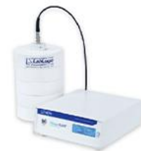
Radio-HPLC:用于放化纯度检测,代谢产物谱研究
